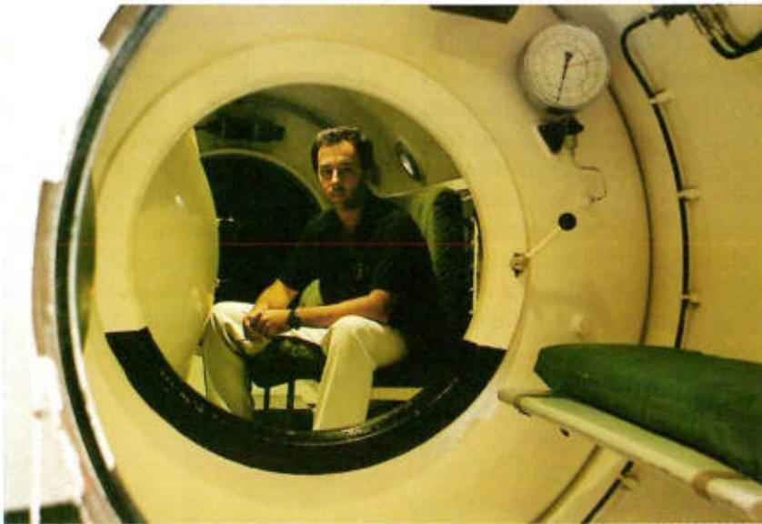
**CÁMARA HIPERBÁRICA MULTIPLAZA.** Consta de dos compartimentos: Antecámara, que permite equilibrar las presiones con el exterior para la entrada y salida del personal sanitario; y la Cámara de tratamiento en sí, donde se encuentra el accidentado.
