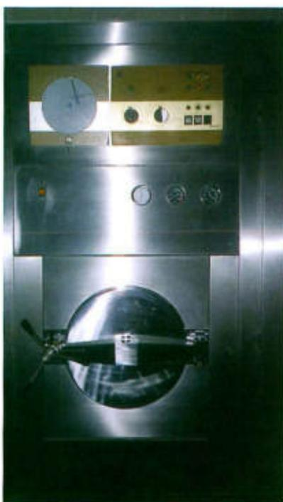
Máquina de esterilización. Riesgo químico debido al óxido de etileno que usa
